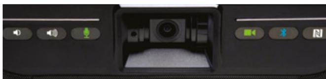
vedere tutti i presenti. L'alto numero di pixel della CS-700 permette di catturare e mostrare qualsiasi espressione fino a 3 metri di distanza dalla camera. Si tratta di un sistema video che richiederà una sola installazione.
